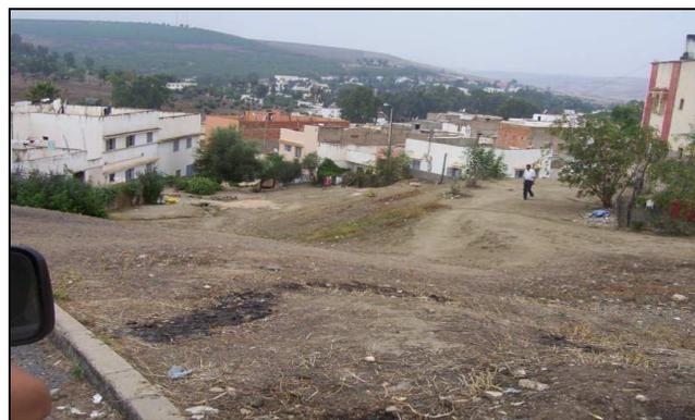
**Photo N°2:** Terres nues emportées par les eaux pluviales provoquant le colmatage des avaloirs
